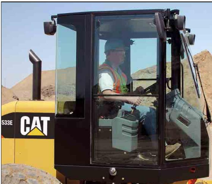
**Cabina.** La cabina de diseño ergonómico proporciona al operador un lugar de trabajo amplio, cómodo y silencioso, con parabrisas y ventanillas amplias, y más espacio interior y para guardar objetos personales.
