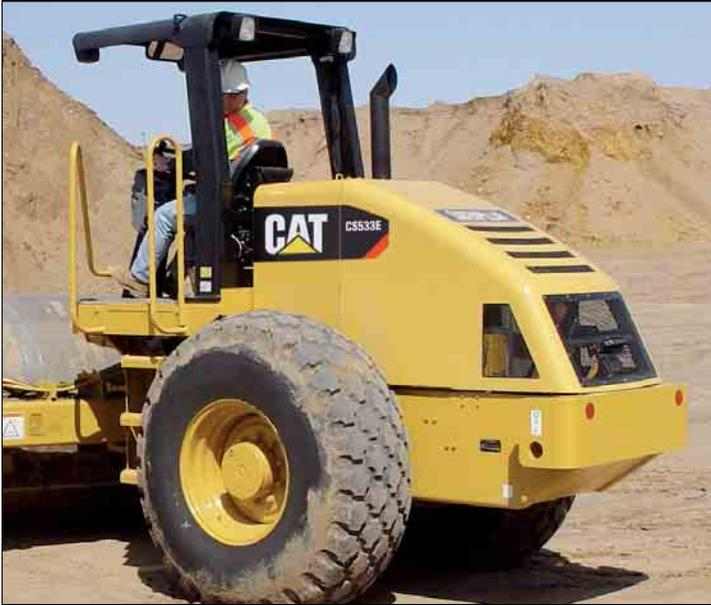
**Visibilidad.** La visibilidad del operador hacia atrás y sobre las ruedas es excepcional. La inclinación del capó del motor permite al operador ver cualquier obstáculo de 1 metro de altura, situado 1 metro detrás de la máquina. Como la visibilidad frontal también es excelente, la productividad de la máquina aumenta por la facilidad para maniobrar junto a obstáculos, construcciones y otras máquinas.
